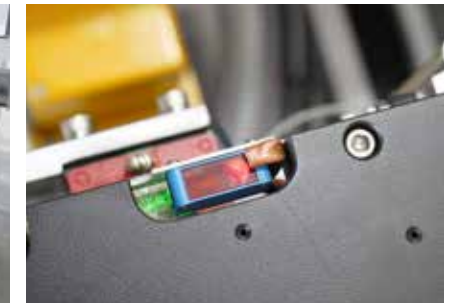
Laser Position Adjustment System Laser Pozisyon Düzeltme Sistemi
